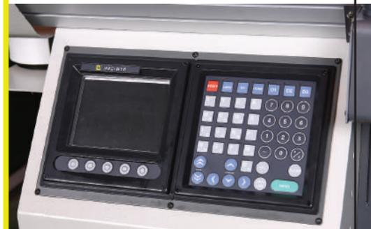
彩色大型LCD螢幕實用按鍵式控制系統，提供織造程式輸入、偵測探錯、織造速度、度目設定、搖床、片數設定等多項功能；可另儲存24組花色程式。亦可選購加裝USB裝置，做為可攜式儲存，更可搭配佰龍提供的專用程式在PC電腦系統上編輯輸入之程式。
