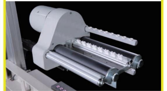
提供側邊紗線輔送裝置，得使織物在織造過程中得到更優良之送紗品質，破孔機率降低，織造速度得以提升，增加產能。
